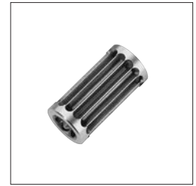
Seite/Page 258 H5050/... Mat.: 1.2343 / 46 + 2 HRC Filtereinsatz für Thermoplastverarbeitung Filter cartridge for processing of thermo-plastics Filtre à gorges pour le traitement des thermoplastes
